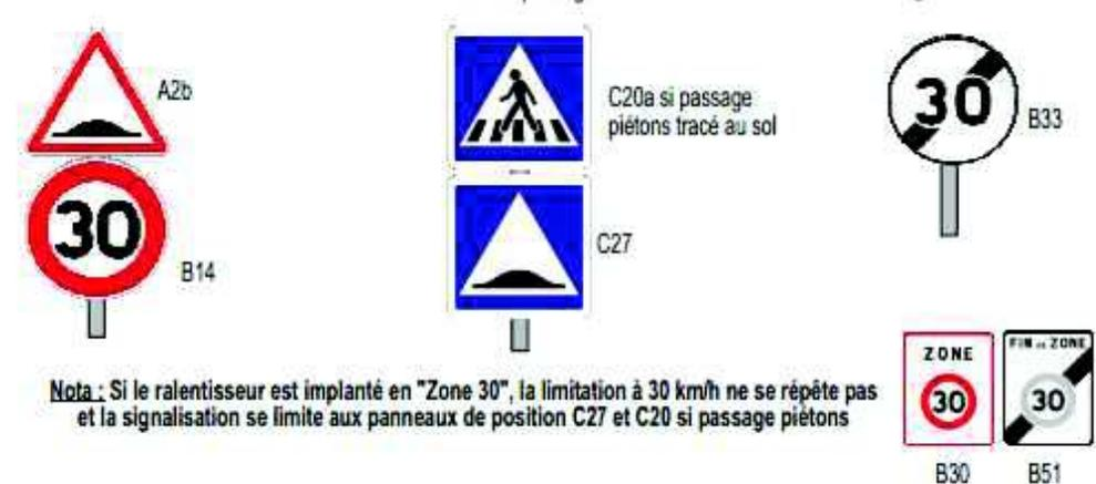
**Nota :** Si le ralentisseur est implanté en "Zone 30", la limitation à 30 km/h ne se répète pas et la signalisation se limite aux panneaux de position C27 et C20 si passage piétons
